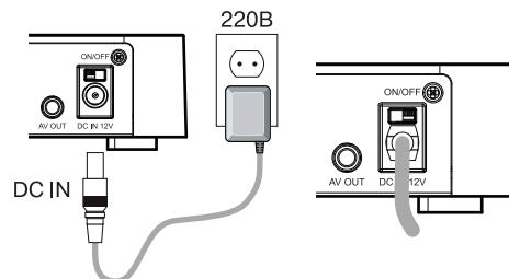
После подключения адаптера питания, переведите выключатель расположенный на задней части ТВ-приёмника - в положение ON
